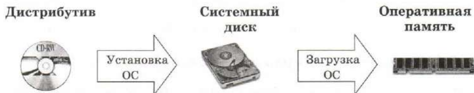
Рис. 1.32. Установка и загрузка операционной системы
