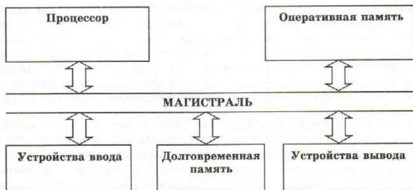
Рис. 1.1. Функциональная схема компьютера
