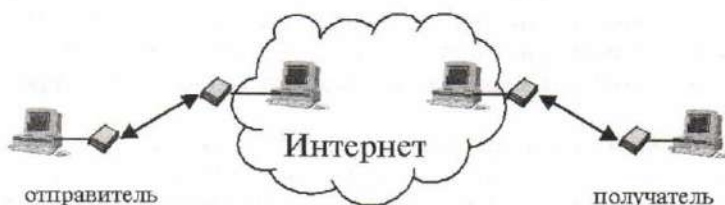
Рис. 4.3. Функционирование электронной почты
