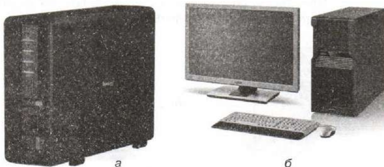
Рис. 1.26. Настольные компьютеры: сервер (а) и рабочая станция (б)
