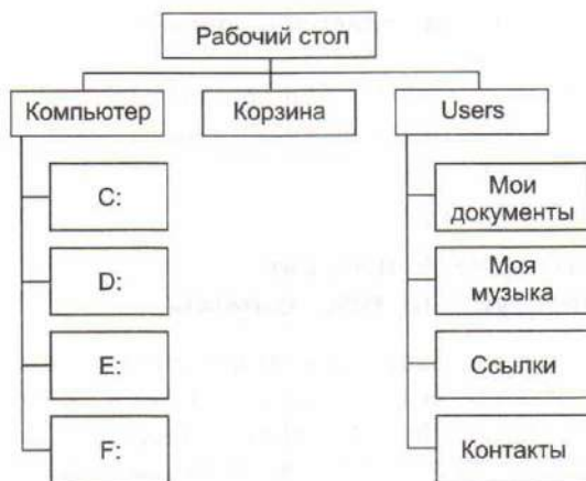
Рис. 1.36. Отображение иерархической системы папок в графическом интерфейсе операционной системы Windows
