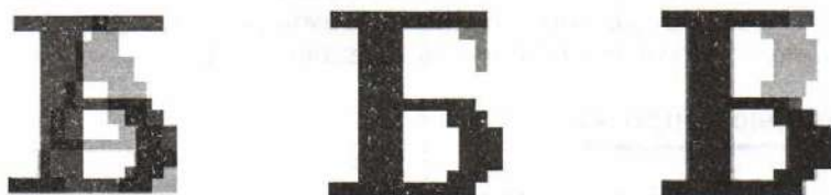
Рис. 2.13. Распознаваемый символ «Б» накладывается на растровые шаблоны символов (А, Б, В и т. д.)
