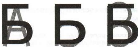
Рис. 2.14. Распознаваемый символ «Б» накладывается на векторные шаблоны символов (А, Б, В и т. д.)
