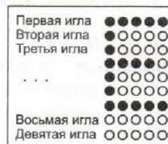
Рис. 1.15. Технология печати матричного принтера
