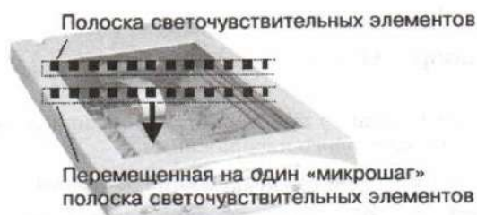
Рис. 2.2. Оптическое и аппаратное разрешение сканера
