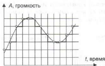
Рис. 3.2. Временная дискретизация звука
